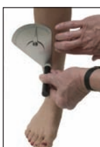
Goniomètre à 2 zéros pour mesures ambidextres. Permet de mesurer le rapport à la verticale dans un plan frontal ou sagittal.
