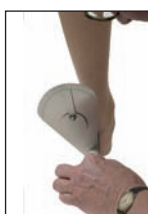
Goniomètre à 2 zéros pour mesures ambidextres. Permet de mesurer le rapport à la verticale dans un plan frontal ou sagittal.
